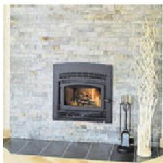
Le foyer au bois, certifié EPA et de fabrication québécoise, est alimenté par une prise d'air extérieur et relié à un réseau qui pousse l'air chaud dans toutes les pièces. Il est agrémenté d'un haut manteau de pierre taillée, de l'ardoise de la Nouvelle-Écosse. Le chauffage est complété par quelques convecteurs électriques. Le bois de chauffage est fourni pour des années à l'avance par les arbres coupés sur le site de la maison.
